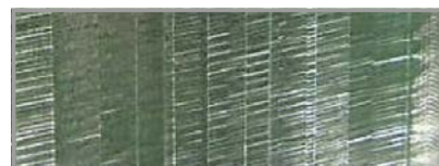
Narzędzie konwencjonalne – ślady od drgań samowzbudnych
